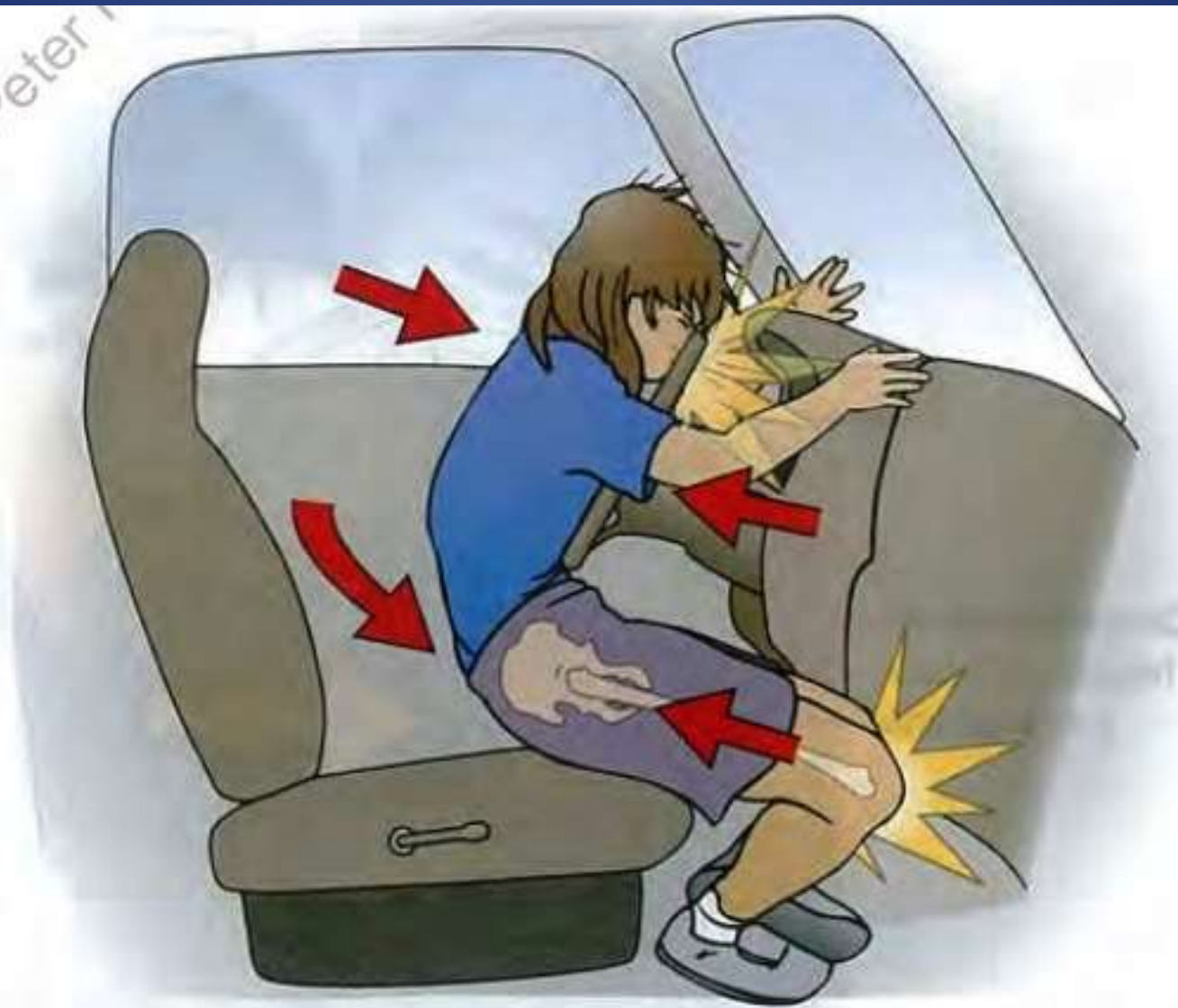
FIGURA 3-11 El ocupante y el vehículo se desplazan hacia delante juntos. El vehículo se detiene y el ocupante no sujeto continúa moviéndose anteriormente, hasta que un objeto detiene este movimiento.
